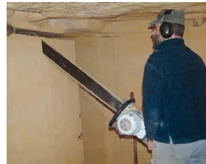
AFBEELDING 4. | Hedendaagse ondergrondse mergelwinning in de Sibbergroeve: langs de zaagsnede. Foto: Firma Kleijnen, Sibbe.
