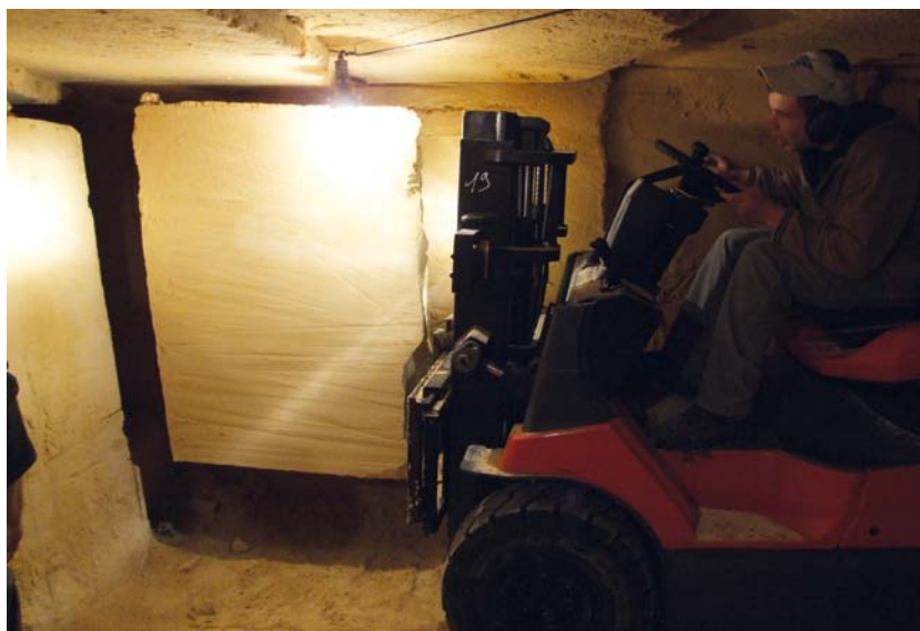
AFBEELDING 2. | Hedendaagse ondergrondse mergelwinning in de Sibbergroeve: het blok. Foto: Firma Kleijnen, Sibbe.
